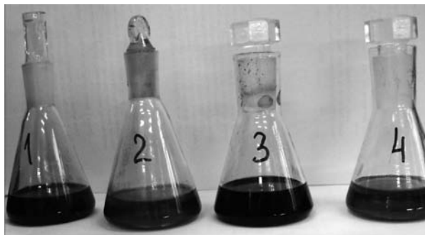
Рис. 3. Растворы каликсаренов 1–4 после барботирования \text{NO}_2/\text{N}_2\text{O}_4 -газом: 1 – раствор каликсарен 1 и \text{NO}_2/\text{N}_2\text{O}_4 , 2 – каликсарен 2 и \text{NO}_2/\text{N}_2\text{O}_4 , 3 – каликсарен 3 и \text{NO}_2/\text{N}_2\text{O}_4 , 4 – каликсарен 4 и \text{NO}_2/\text{N}_2\text{O}_4
